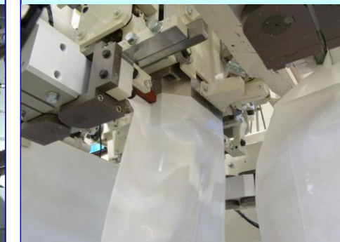
開口クランプ充填部
