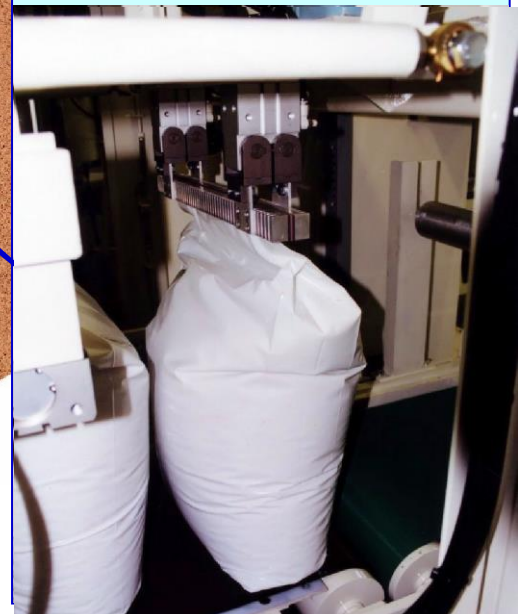
トップシール冷却部 (2箇所)
