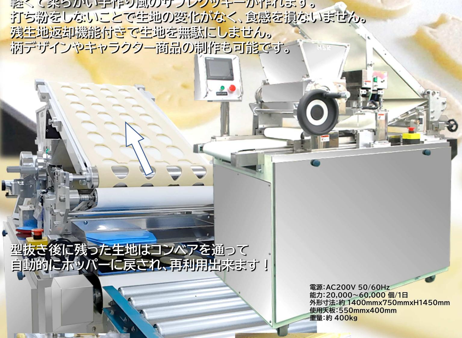
型抜き後に残った生地はコンベアを通過して自動的にホッパーに戻され、再利用出来ます！
