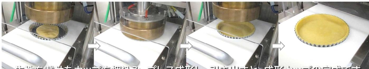
生地を載せたカップを押込み、プレス成形し、引き出すと、成形カップの完成です
